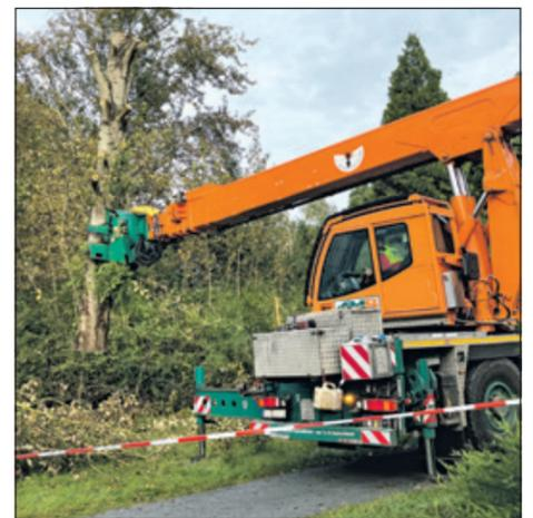
Der Fällkran kann ganze Baumteile kontrolliert entnehmen und ablegen.
