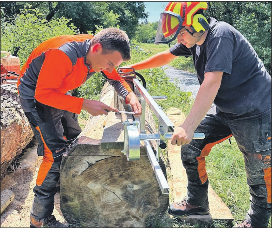
Mühsam schnitten Finn Ammelung und Ole Heeger die obere Kante der rund vier Meter langen Sitzbank aus dem Pappelstamm. Foto: Hessenforst
