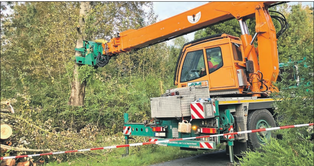
Ein Fällkran kann ganze Baumteile kontrolliert entnehmen. Foto: Willig/Hessenforst
