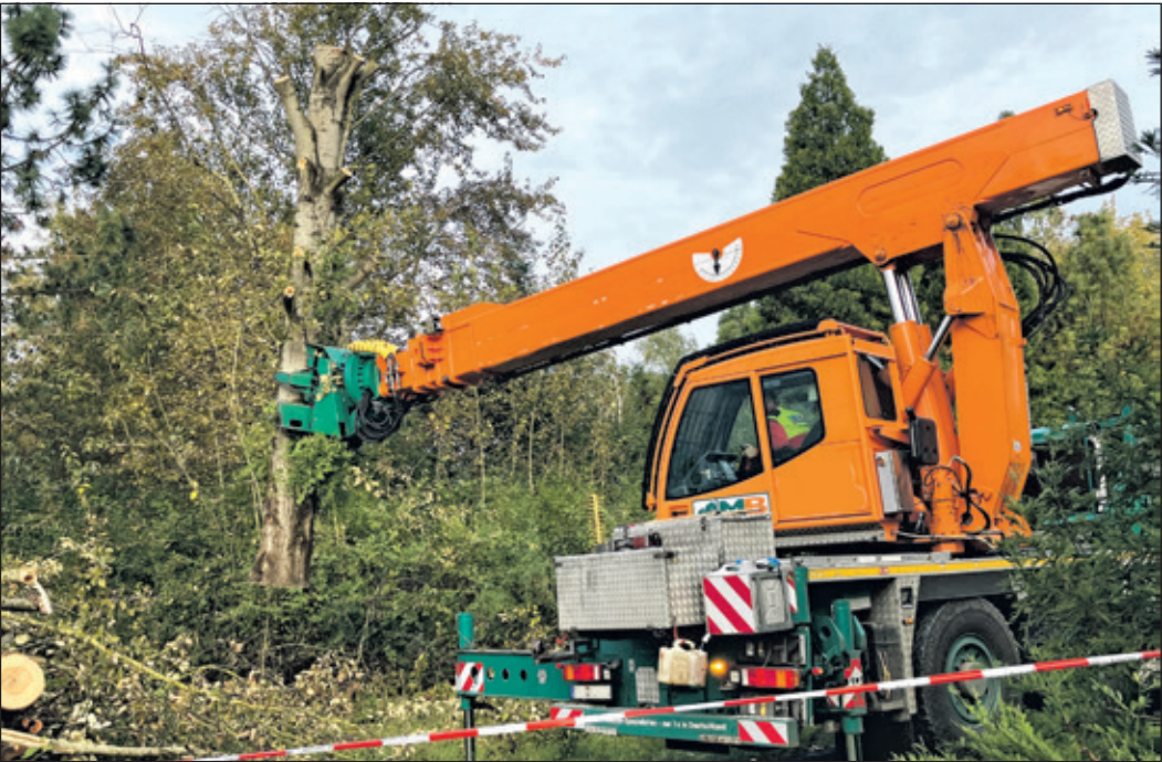
Der Fällkran kann ganze Baumteile kontrolliert entnehmen und ablegen. Foto: Thorsten Willig, HessenForst Forstamt Königstein.
