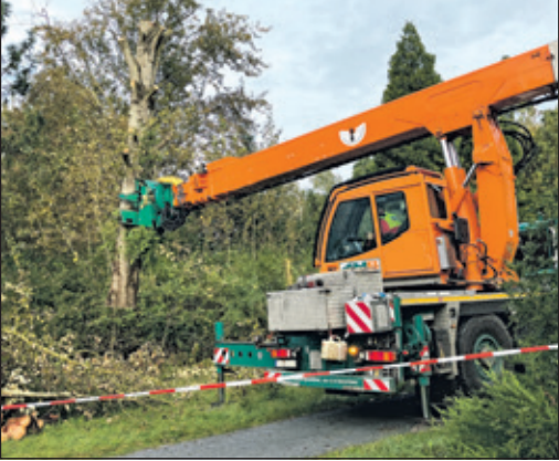
Fllkran im Einsatz zur Baumpflege Foto: Willig/Forstamt Knigsstein
