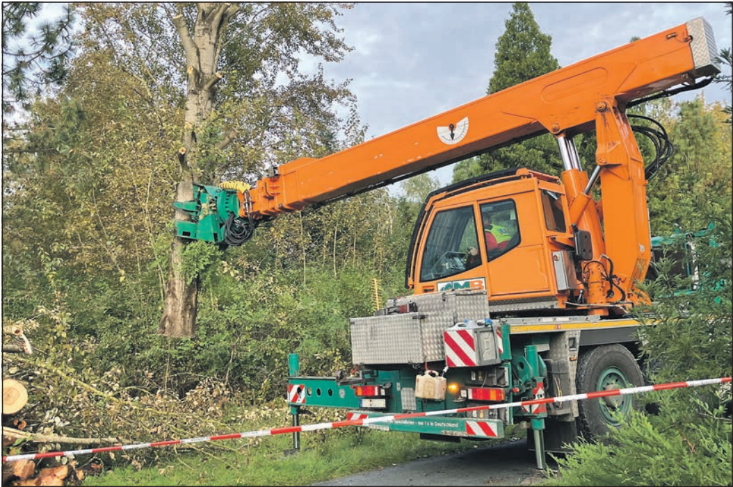
Ein Fällkran entnimmt gezielt und bestandespfleglich Baumteile. Foto: Willig/Hessen-Forst
