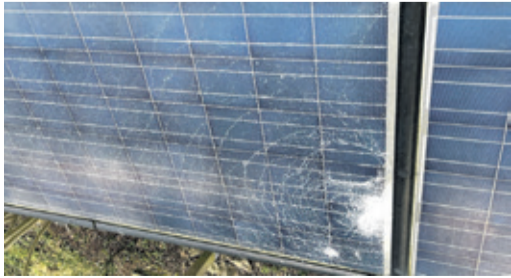
Lose und herabfallende Dachziegel können nicht nur Schäden an der eigenen PV-Anlage oder dem Gebäude hinterlassen. Auch Passanten, parkende PKW oder das Nachbargrundstück sind gefährdet. (Foto: epr/Friedrich Ossenberg-Schule/Wim Coppens)
