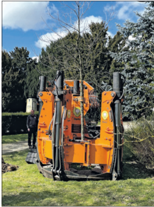
Die Großbaumverpflanzmaschine platziert die Edelkastanie genau über dem Loch.
