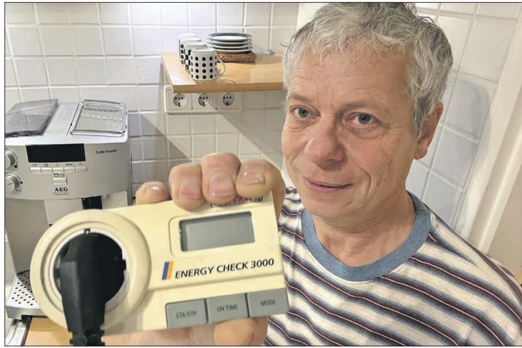
So schaut das Strommessgerät aus, mit dem problemlos der Stromverbrauch eines Gerätes gemessen werden kann. Foto: IG Nachhaltigkeit
