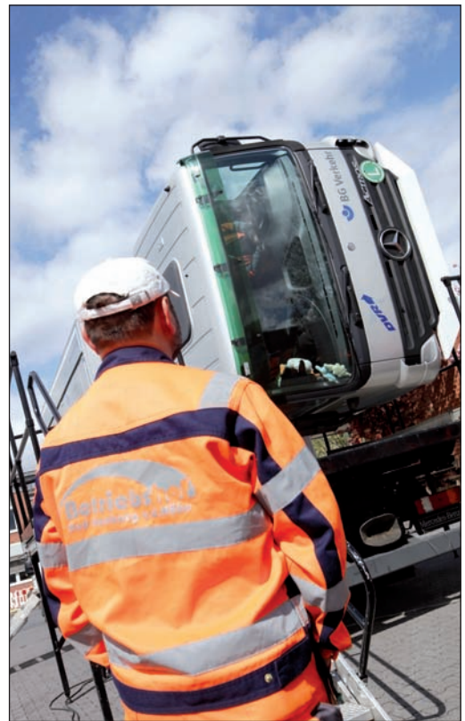
Beim Überschlagsimulator dreht sich eine Lastwagenkabine um die eigene Achse. Es soll dabei demonstriert werden, dass ein Gurt für die Insassen mehr Sicherheit bietet. Foto; sto
