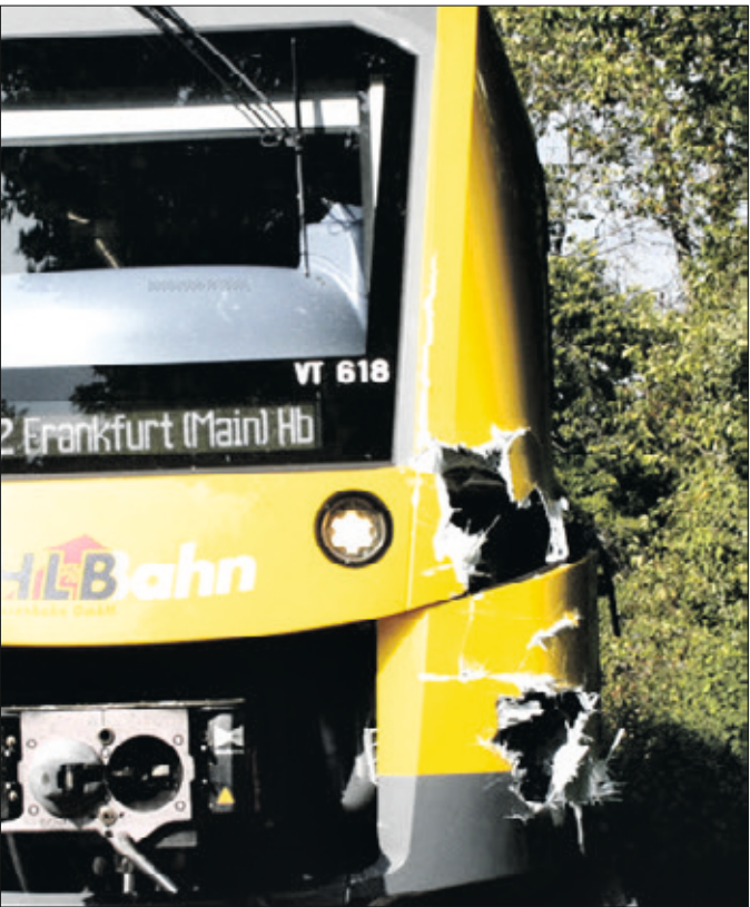
Aufgerissenes Blech an der Vorderseite des Triebwagens: ein relativ kleiner Schaden, der entstand.
