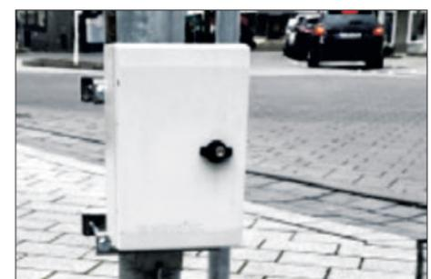
So sieht der kleine „schlaue“ Kasten aus, der für die Statistik das Fahrverhalten von Autofahrern registriert.
