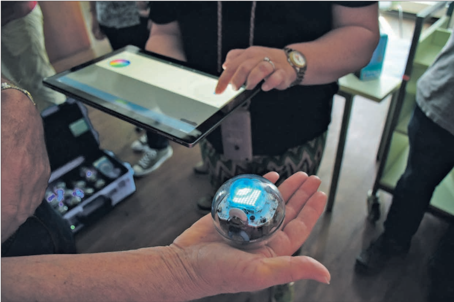
Dieser kleine Roboter lässt sich per iPad programmieren und steuern. Wie eine Art Puzzle können die Befehle für den Miniroboter zusammengestellt werden, von Farb- und Richtungswechsel bis zum Abspielen von Sprache und Musik. Fotos: Judith Ulbricht
