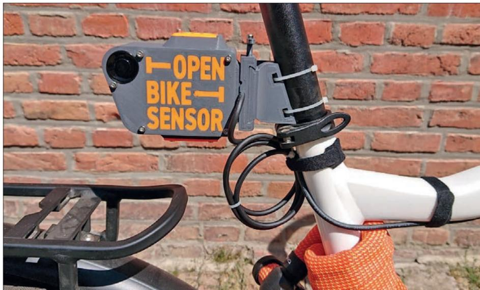
Der OpenBikeSensor wird an der Sattelstütze montiert.
