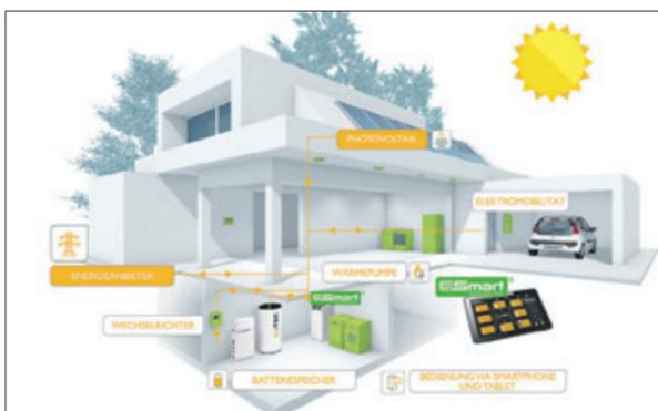
Moderne Wärmepumpen können mit Photovoltaik- und PV-Terminal-Anlagen kombiniert werden – eine Lösung für Reihenhäuser, bei denen im Garten kaum Platz für die Anlage zur Verfügung steht. Grafik: M-Tec
