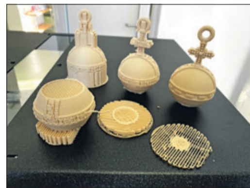
Der „Werdegang“ eines 3D-Modells: Die Gitter geben dem Modell die notwendige Stabilität, die „Stützen“ müssen nach dem Druck entfernt werden. Foto: Scholl
